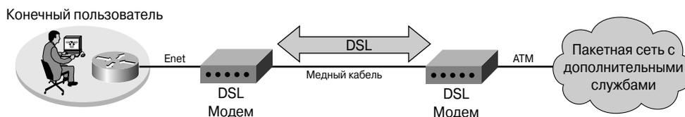
Рис. 12.20. DSL-соединение
